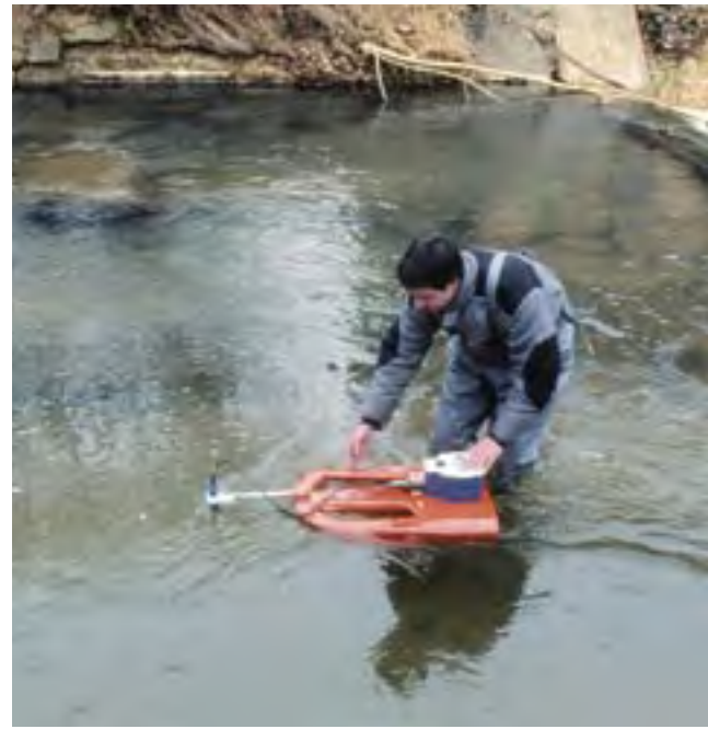
La différence de pression hydrostatique, dans une mesure pneumatique, permet de déterminer le niveau d'eau (à gauche). Le système acoustique doppler (à droite) permet de mesurer simultanément la vitesse d'écoulement et la profondeur de l'eau.
