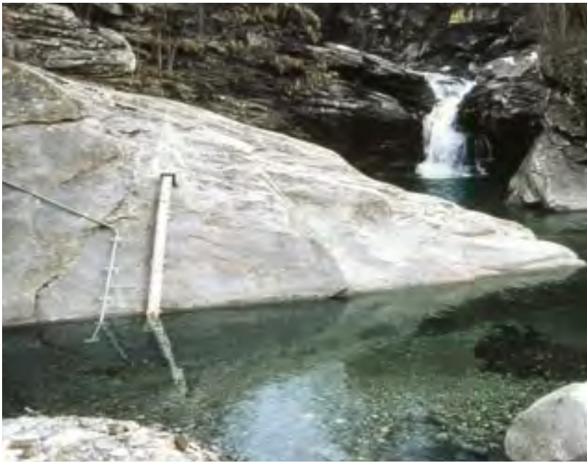
La différence de pression hydrostatique, dans une mesure pneumatique, permet de déterminer le niveau d'eau (à gauche). Le système acoustique doppler (à droite) permet de mesurer simultanément la vitesse d'écoulement et la profondeur de l'eau.
