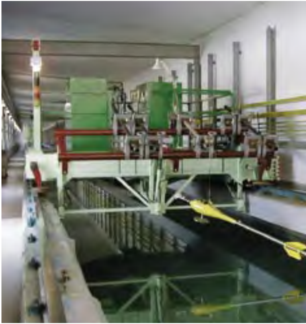
Les moulinets hydrométriques, comme d'autres appareils, sont calibrés dans le canal d'étalonnage de l'OFEG à Ittigen BE (voir cadre). Ces instruments sont utilisés pour mesurer la vitesse d'écoulement des cours d'eau.
